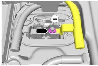
Retire la tuerca del borne de masa de la batería de arranque. Suelte y vuelva a colocar el cable de masa de la batería de arranque.
