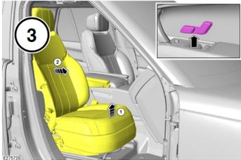
Eleve el asiento de la fila delantera. Vuelva a colocar el asiento de la fila delantera hacia delante.
