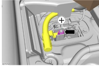
Retire la tuerca del borne positivo de la batería de arranque. Suelte y vuelva a colocar el cable positivo de la batería de arranque.
