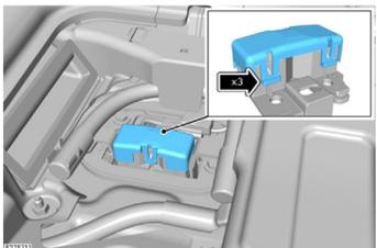
Suelte las 3 abrazaderas. Retire la cubierta del borne de la batería de arranque.
