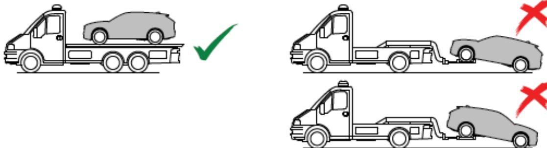
Si el vehículo no se puede rescatar con el método recomendado, en caso de emergencia y si es estrictamente necesario, se puede remolcar sobre las cuatro ruedas durante una distancia corta. No remolque el vehículo durante más de 50 km (30 millas). No supere los 50 km/h (30 mph).
